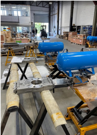
KGT01 inox équipées de réservoirs d'air : réserve de manœuvre autonome et alimentation des rampes d'injection air / vapeur. Stainless KGT01 fitted with air receivers: autonomous stroke reserve and supply to the air / steam injection manifolds.
