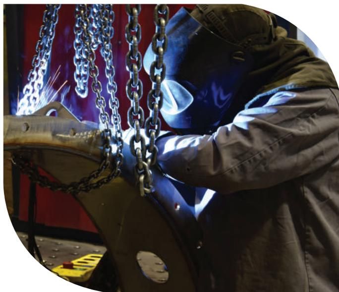
Soudure des corps de vannes.
